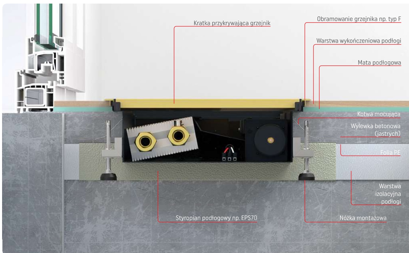
Przykład posadzenia grzejnika kanałowego z wentylatorem (widok z boku)
